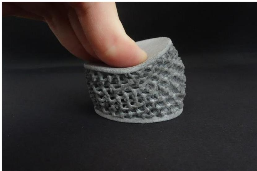
△具有可变特性的 voxeljet 灰度 3D 打印部件
